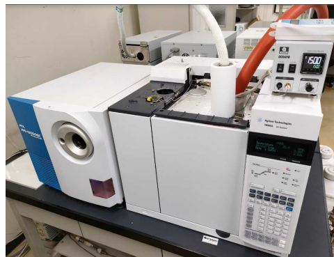
ガスクロマトグラフ質量分析計 (消毒副生成物の検査に使用)
