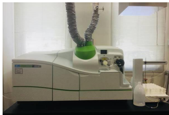
誘導結合プラズマ質量分析計（ICP-MS） (金属類の検査に使用します)
