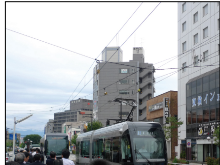
シンプルカテナリー方式吊架例
