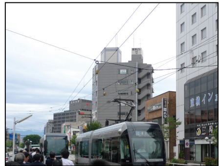
シンプルカテナリー方式吊架例
