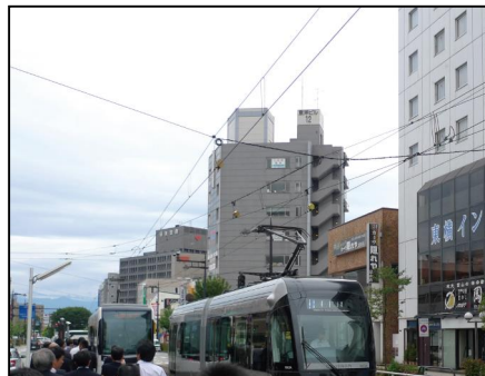
シンプルカテナリー方式吊架例
