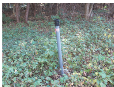
44：旧地下水位観測孔
