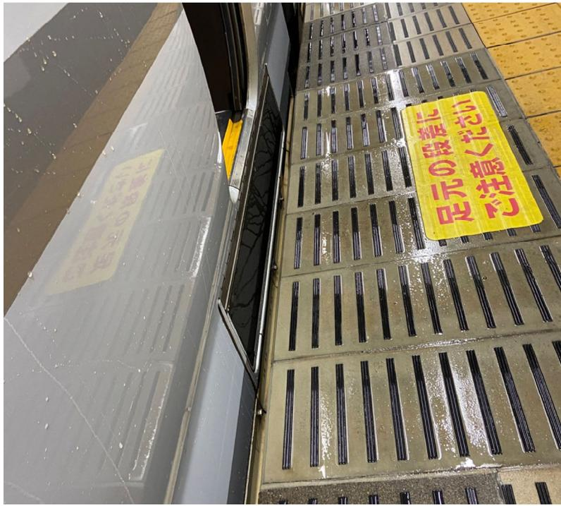
写真 大曲駅：秋田新幹線 ミニ新幹線車両とホームとの段差
