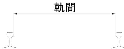
軌間が異なる乗り入れは困難であるため、軌間は鉄道の重要な要素の1つである。**在来線(普通鉄道)**は狭軌 **1,067mm NG (Narrow Gauge)**、**新幹線(フル規格・ミニ新幹線ともに)**は標準軌 **1,435mm SG (Standard Gauge)**である。そのため、在来線に新幹線を乗り入れるには、三線線軌条や改軌が必要となる。三線線軌条や改軌の場合、在来線と新幹線の軌間中心が  $184\text{mm} = (1,435 - 1,067) / 2$  ずれるため、軌道中心間隔の確保やホーム削正等の対応が必要となる。
