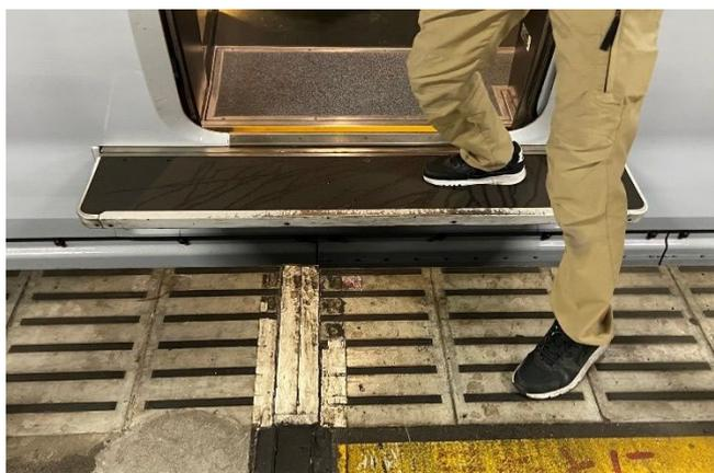
図 自動収納ステップの例（JR 東日本 E6 系）
