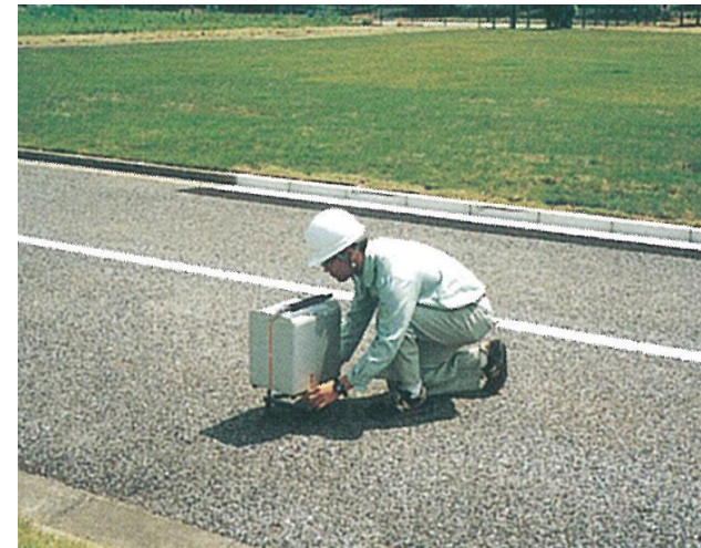
図2 重力探査作業状況（事例）
