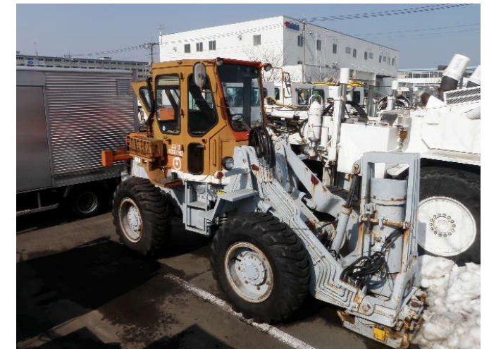
図3 弾性波探査に使用する油圧インパクト（事例）
