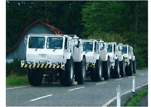
図3 起振車（大型バイブレーター）による探査状況（事例）
