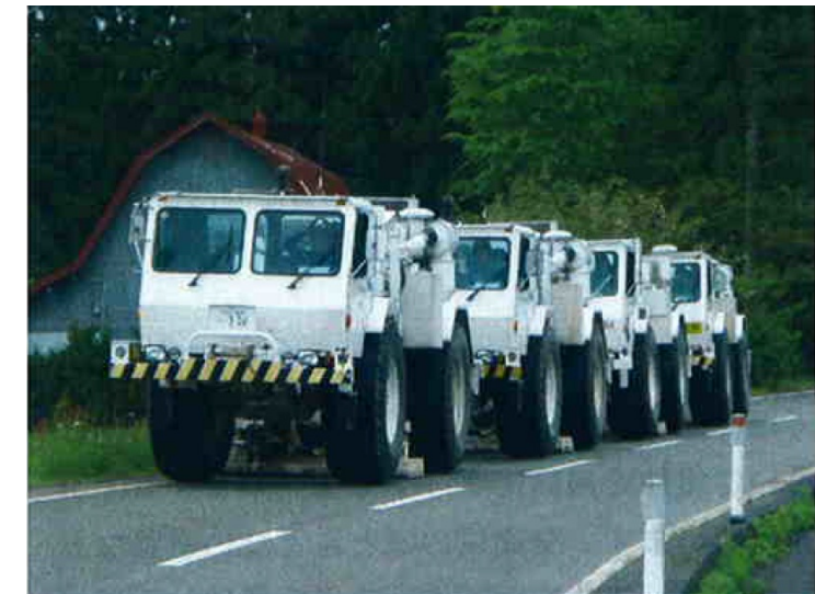
図3 起振車（大型バイブレーター）による探査状況（事例）
