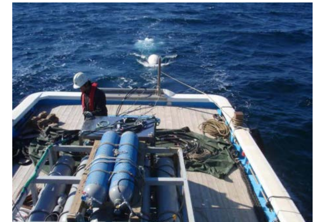
図 5 曳航式音波探査状況
