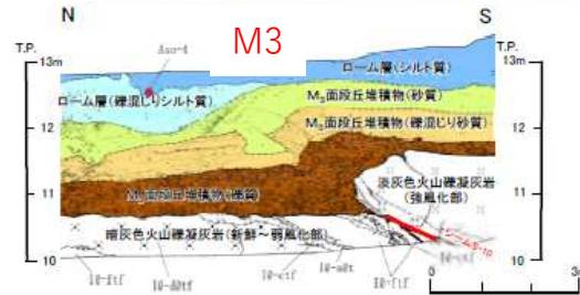
Ts-1トレンチ東側面: 変状が認められる (比高約35cm〔岩盤の段差及び段丘堆積物中の層理面の段差〕) (補足説明資料P.4-28, P.4-58~P.4-67参照)
