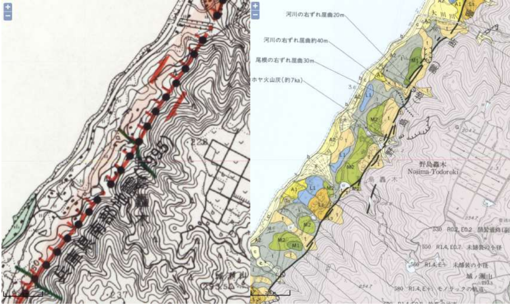
野島断層の活断層（左図）と1995年兵庫県南部地震の地表地震断層（右図）
