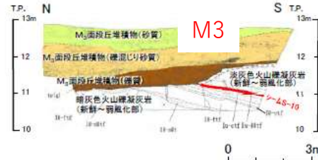
Ts-2トレンチ東側面: 変状が認められない (補足説明資料P.4-33参照)
