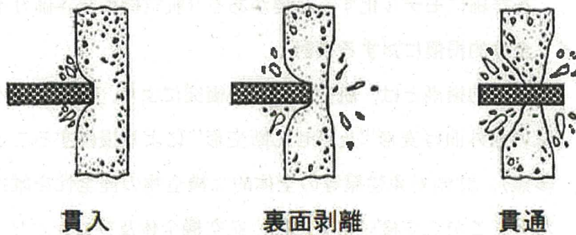
図4 貫入, 裏面剥離, 貫通のイメージ
