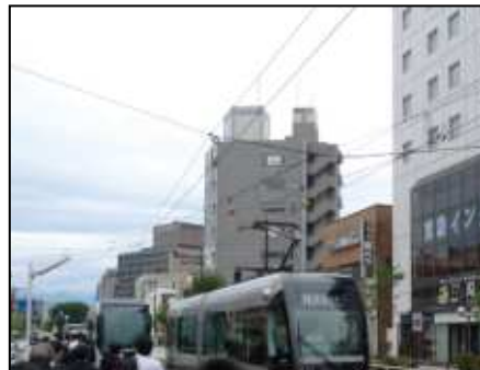
シンプルカタナリー方式吊架例
