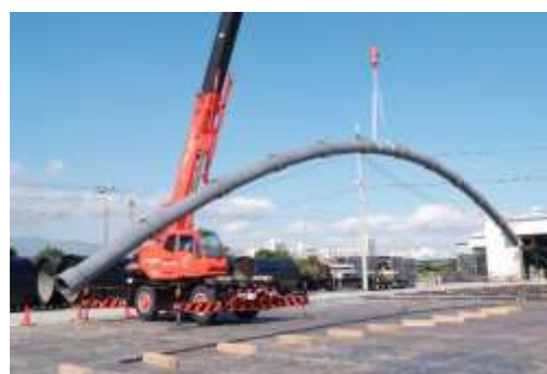
耐震継手の水道管
