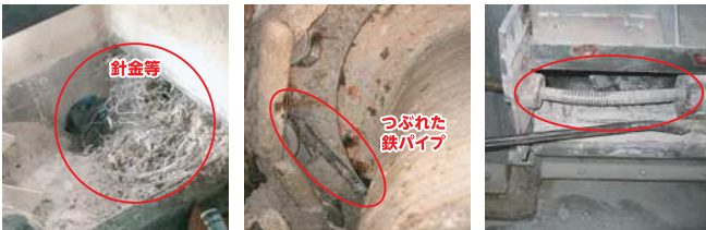
装置に混入 装置に絡んで停止 金属部に挟まりコンベヤが変形
