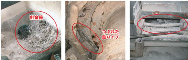
装置に混入      装置に絡んで停止      金属部に挟まりコンベヤが変形
