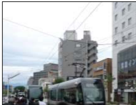
シンプルカテナリー方式吊架例
